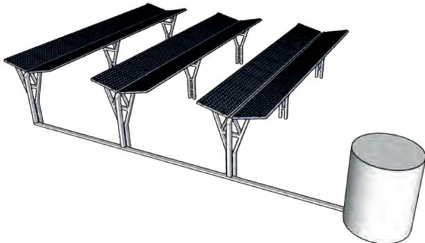
Abb. 55: Konzept einer Regenauffangvorrichtung mit Speichertank. © Fraunhofer ISE
