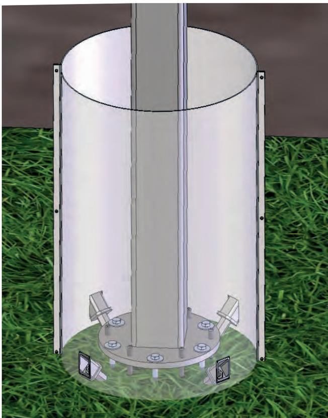
Abb. 29: Rammschutz der Aufständerung der Anlage in Heggelbach gegen mögliche Beschädigungen durch Landmaschinen.
