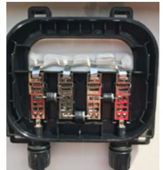
Abbildung 13: Aufbau einer Modul-Anschlussdose mit Bypass-Dioden
