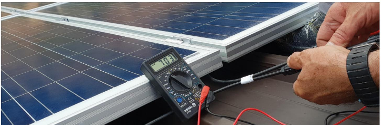
Abbildung 115: Funktionstest von Solarmodulen
