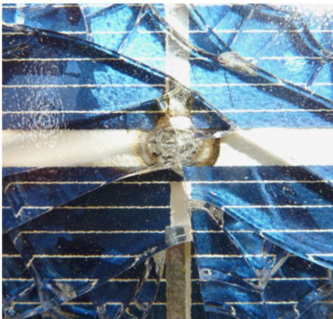
Abbildung 114: Blitzschaden an einem Solarmodul
