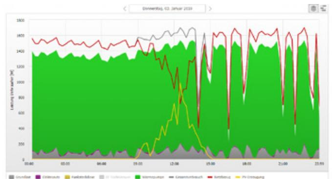
Abbildungen 84/85: Lastgang (grün) einer Wärmepumpe an einem Sommertag und einem Wintertag (gelb Solarertrag, grau Grundlast)
