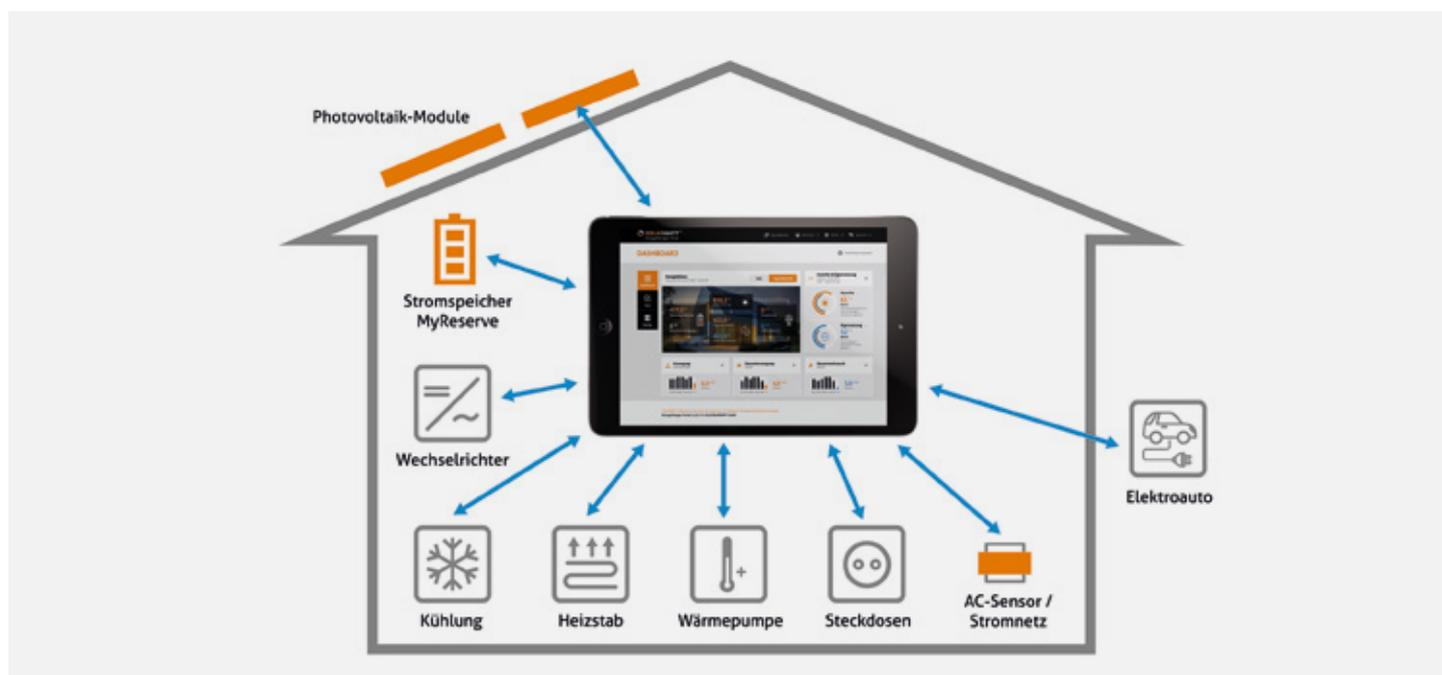
Abbildung 72: Beispiel Energiemanagementsystem für die Steuerung unterschiedlicher Verbraucher
