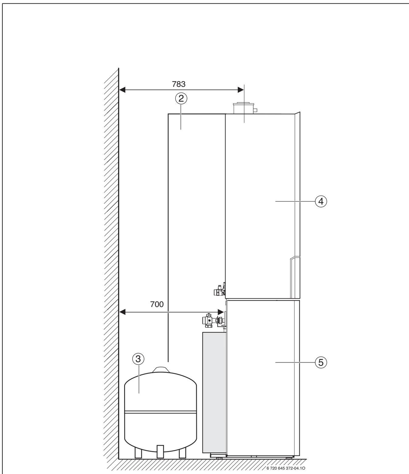
Bild 4 Montagebeispiel - Pufferspeicher rechts vom Gerät
