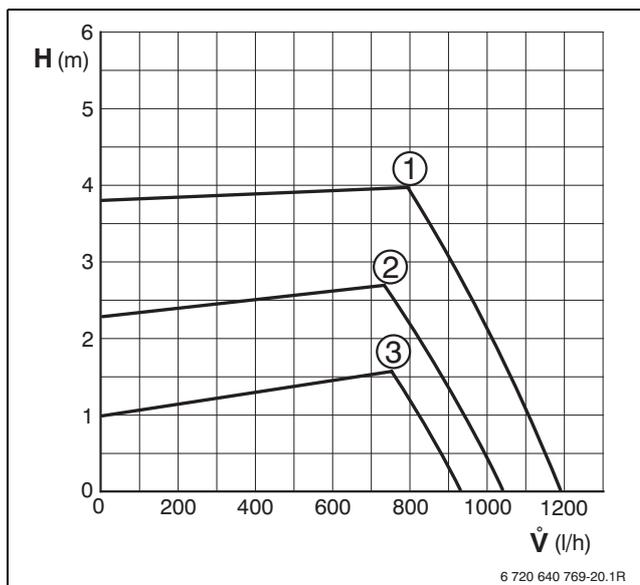
Bild 55 Konstantdruck - Gerät ohne Pufferspeicher und Verrohrung
