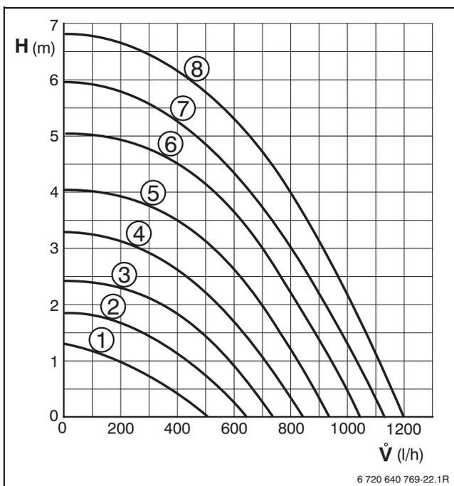
Bild 59 Pumpenkennlinien - Gerät ohne Pufferspeicher und Verrohrung
