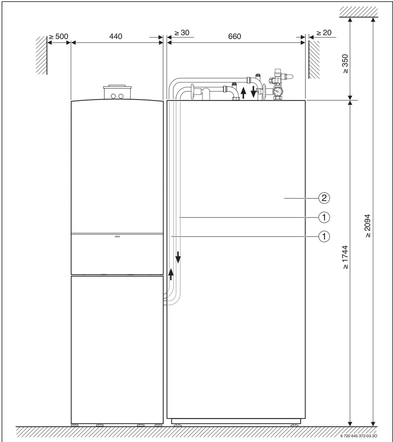
Bild 3 Montagebeispiel - Pufferspeicher rechts vom Gerät
