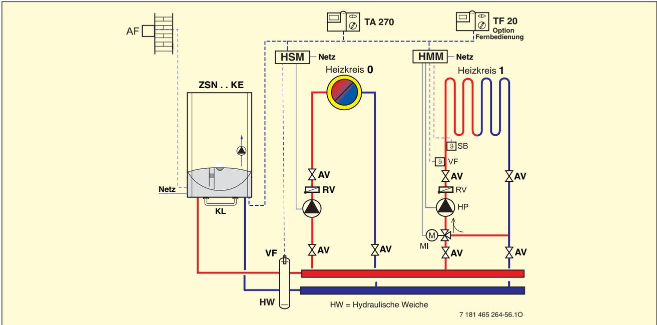
Bild 82 CERANORM/CERAMINI bei reinem Heizbetrieb
