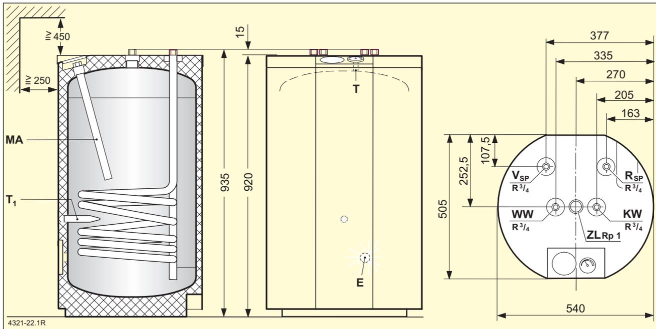
Bild 38 Bau- und Anschlussmaße ST 120-1 Z
