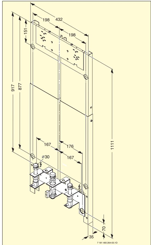
Bild 63 Vormontageeinheit, eingestellt für ZSN 18-6
