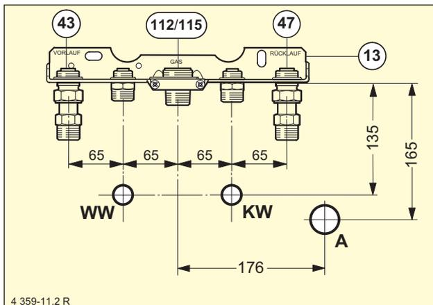
Bild 44 Aufputzanschlüsse mit Wandabstand 60 mm.
