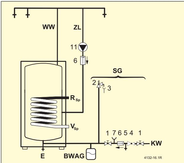
Bild 16 Warmwasserseitiges Anschluss-Schema
