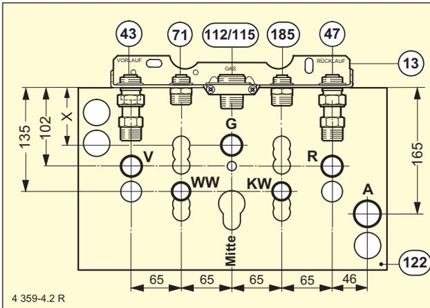
Bild 34 Unterputzanschlüsse
