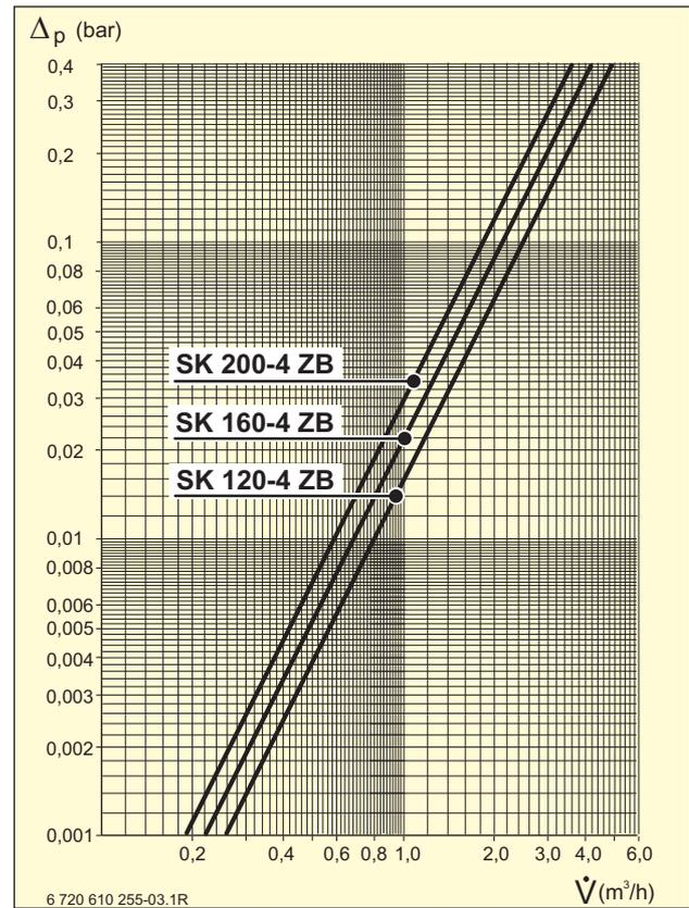
Bild 57 Druckverlust der Heizschlange in bar
