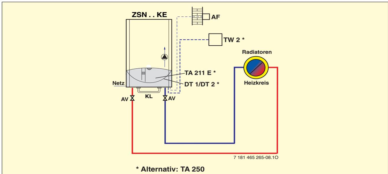
Bild 80 CERANORM/CERAMINI bei reinem Heizbetrieb
