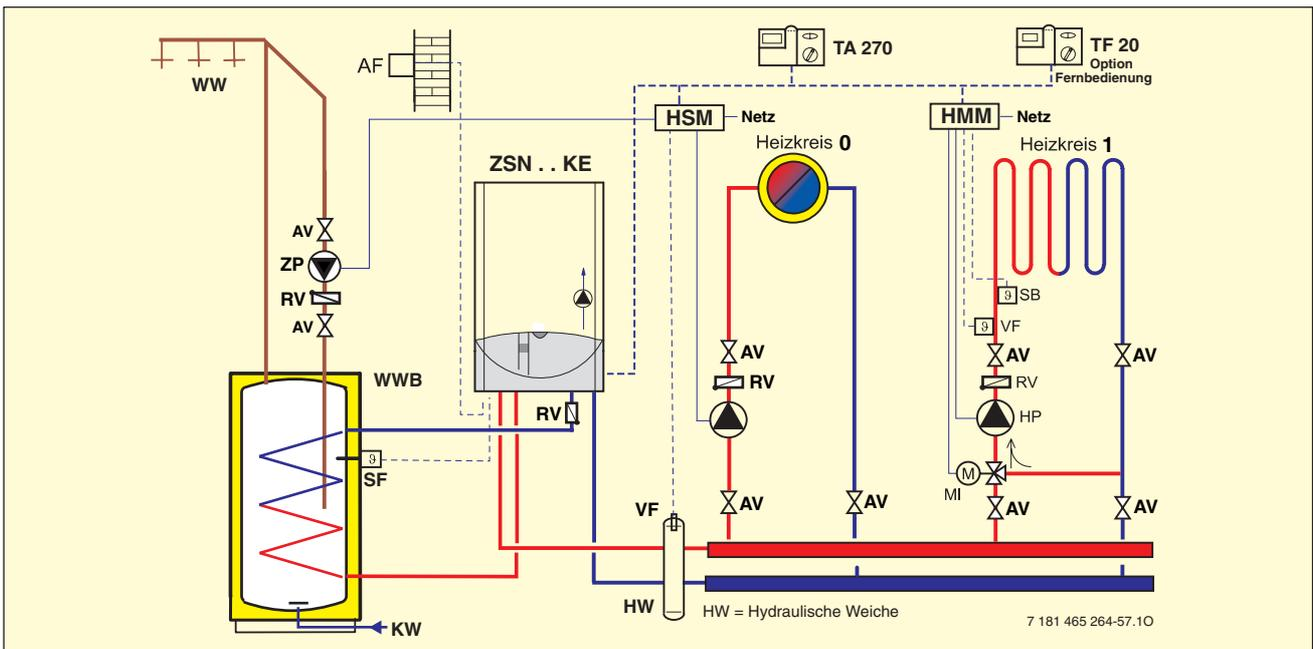
Bild 83 CERANORM/CERAMINI mit angeschlossenem Warmwasser-Speicher
