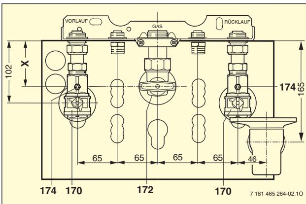
Bild 60 Montageanschlussplatte mit Unterputz-Installation (fertig montiert)
