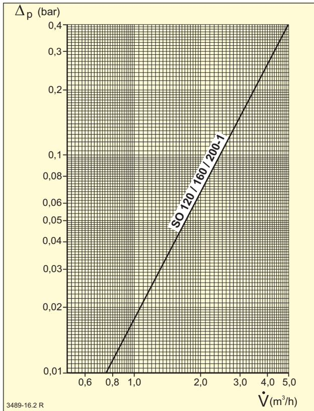
Bild 56 Druckverlust der Heizschlange in bar
