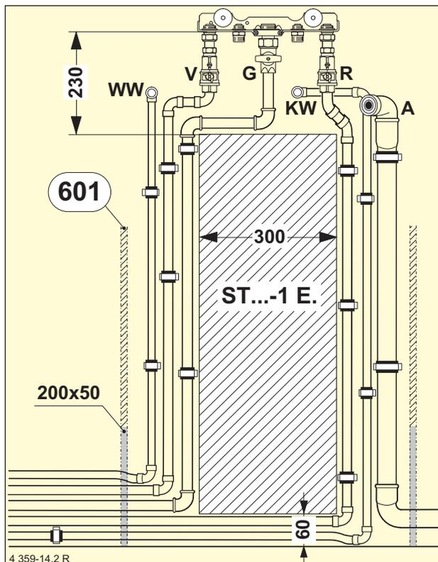
Bild 47 Bauseitige Aufputzverrohrung ohne Wandabstand.
