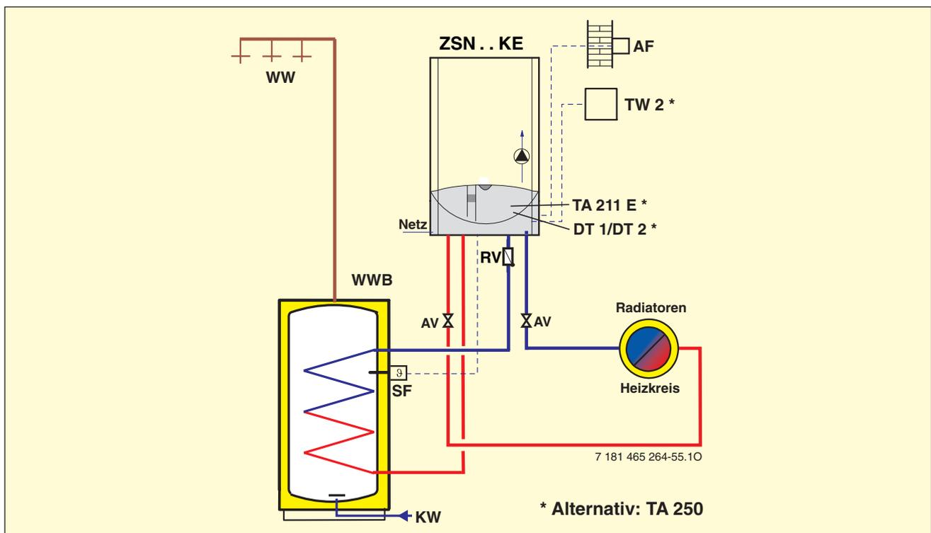
Bild 81 CERANORM/CERAMINI mit Warmwasser-Speicher
