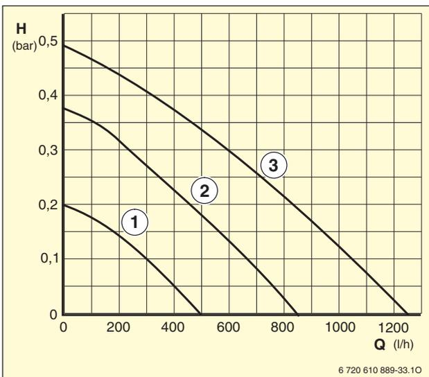
Bild 11 Pumpenkennlinien bei ZSN 18-6 KE
