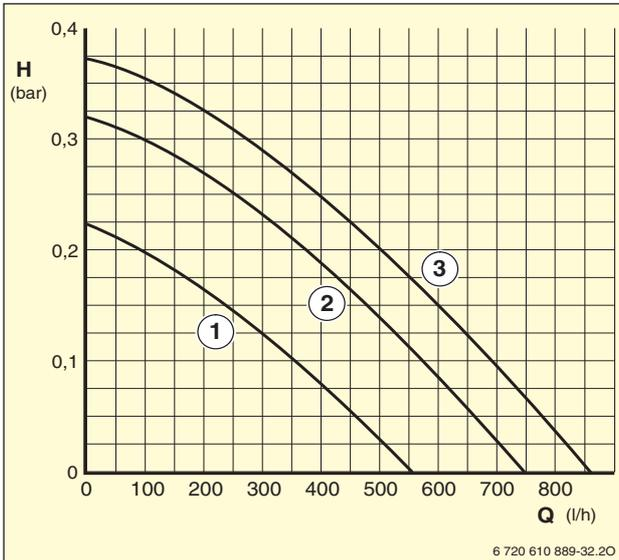
Bild 10 Pumpenkennlinien bei ZSN 5/11-6 KE
