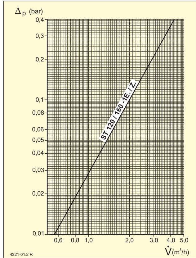
Bild 49 Druckverlust der Heizschlange in bar
