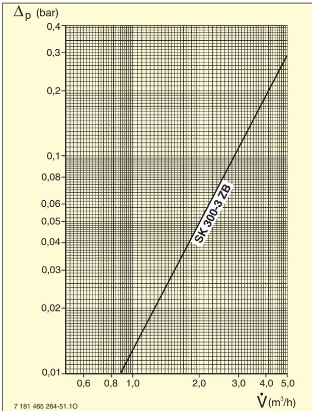
Bild 58 Druckverlust der Heizschlange in bar
