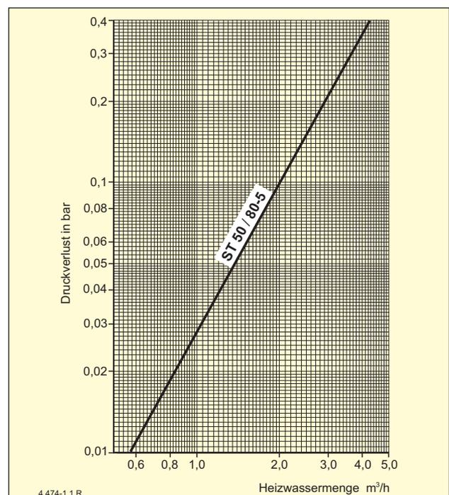
Bild 25 Druckverlust der Heizschlange in bar
