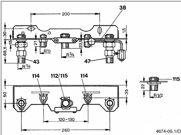
Bild 59 Montageanschlussplatte
