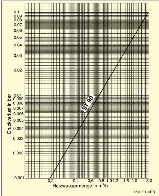
Bild 36 Druckverlust der Heizschlange in bar
