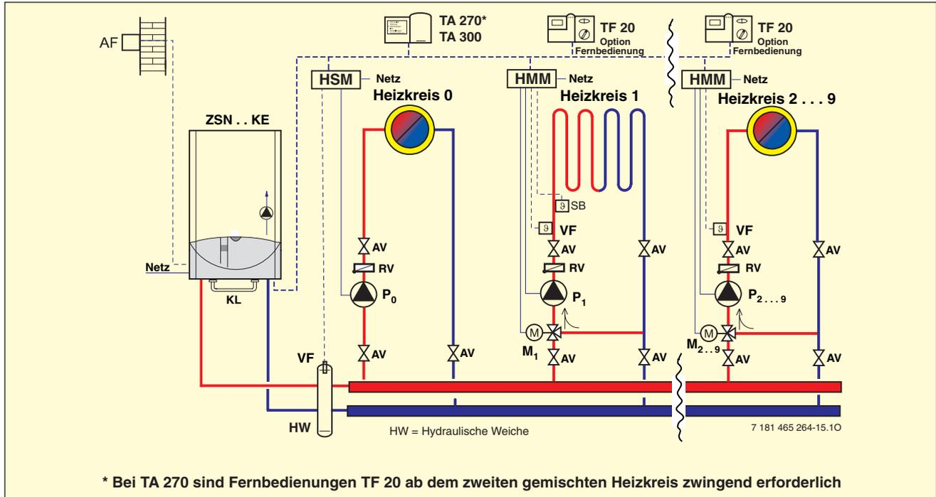
Bild 84 CERANOR/CERAMINI bei reinem Heizbetrieb
