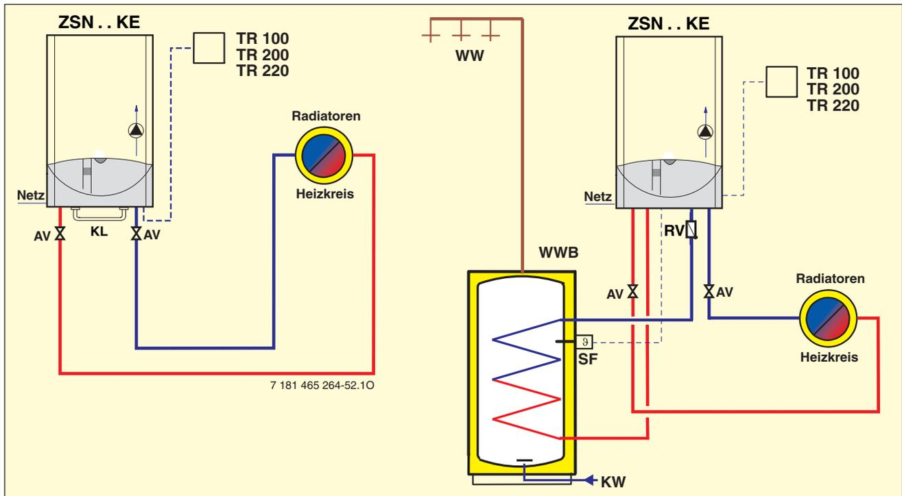
Bild 78 CERANORM/CERAMINI bei reinem Heizbetrieb (links) bzw. mit Warmwasser-Speicher (rechts)
