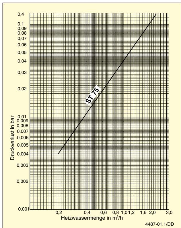
Bild 31 Druckverlust der Heizschlange in bar
