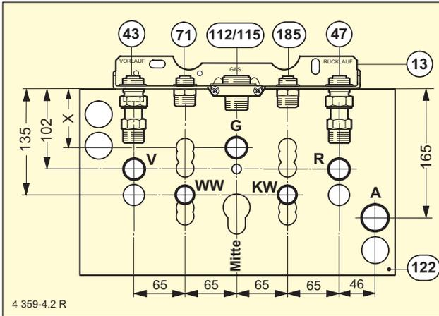
Bild 42 Unterputzanschlüsse
