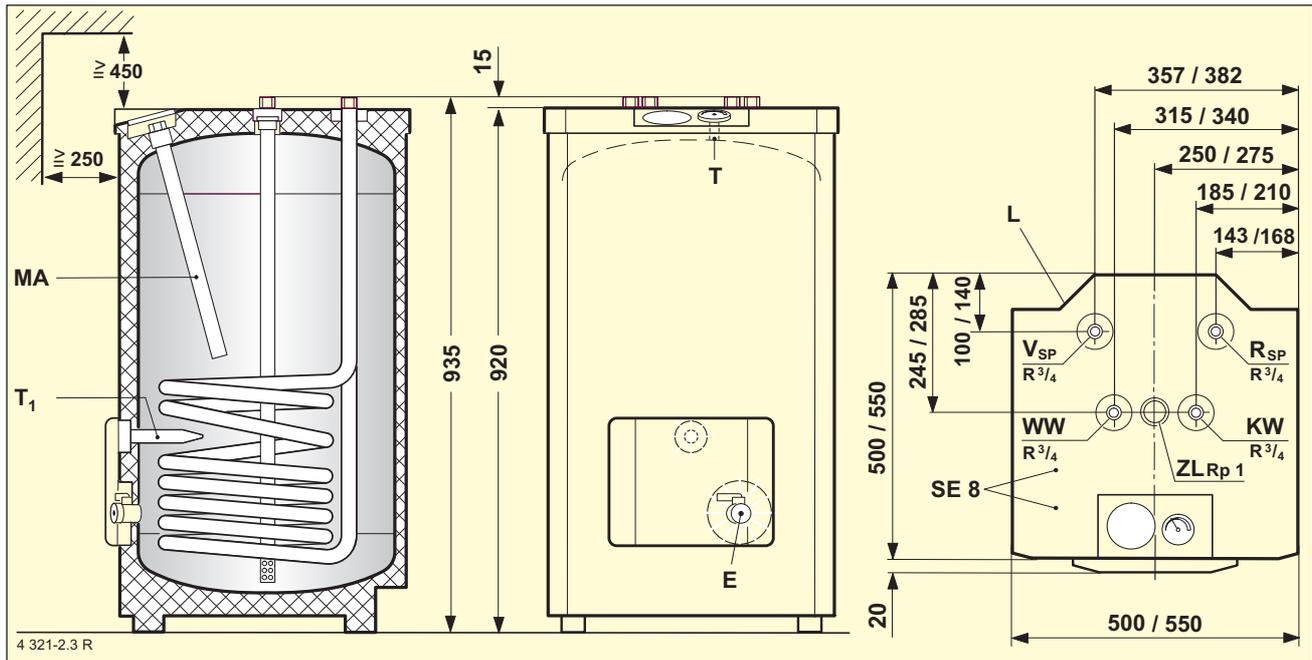
Bild 37 Bau- und Anschlussmaße ST 120-1 E. und ST 160-1 E. (Maßangaben hinter einem Schrägstrich beziehen sich auf die größere Speicherausführung)
