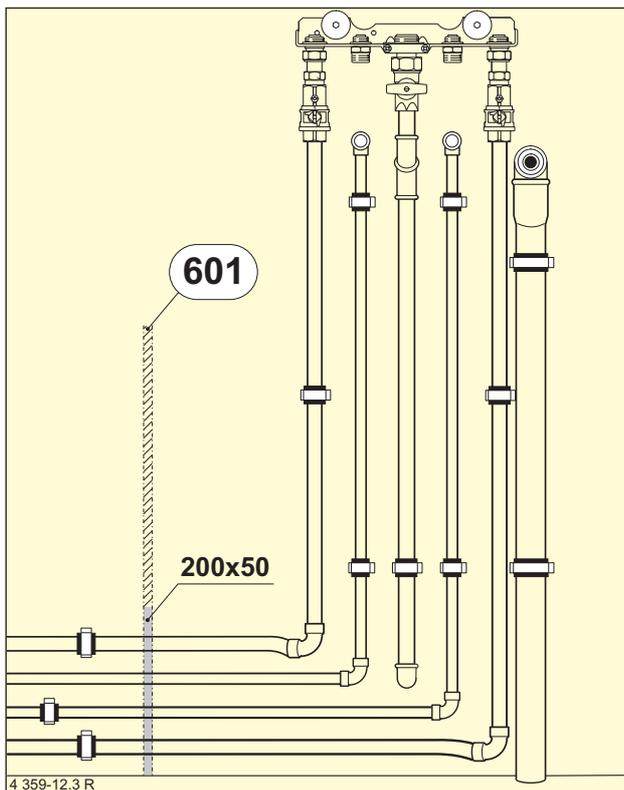
Bild 45 Bauseitige Aufputzverrohrung mit 60 mm Wandabstand.
