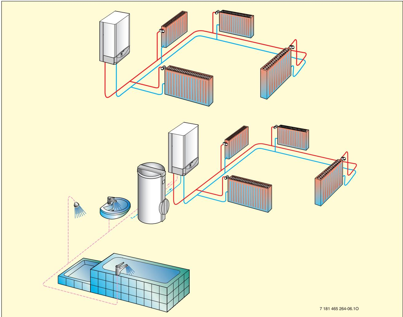
Bild 5 Anschlussschemata für reinen Heizbetrieb (oben) und in Kombination mit einem Warmwasserspeicher
