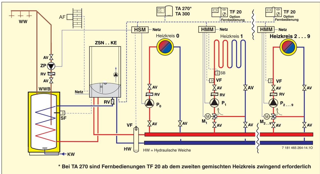
Bild 85 CERANOR/CERAMINI mit angeschlossenem Warmwasser-Speicher
