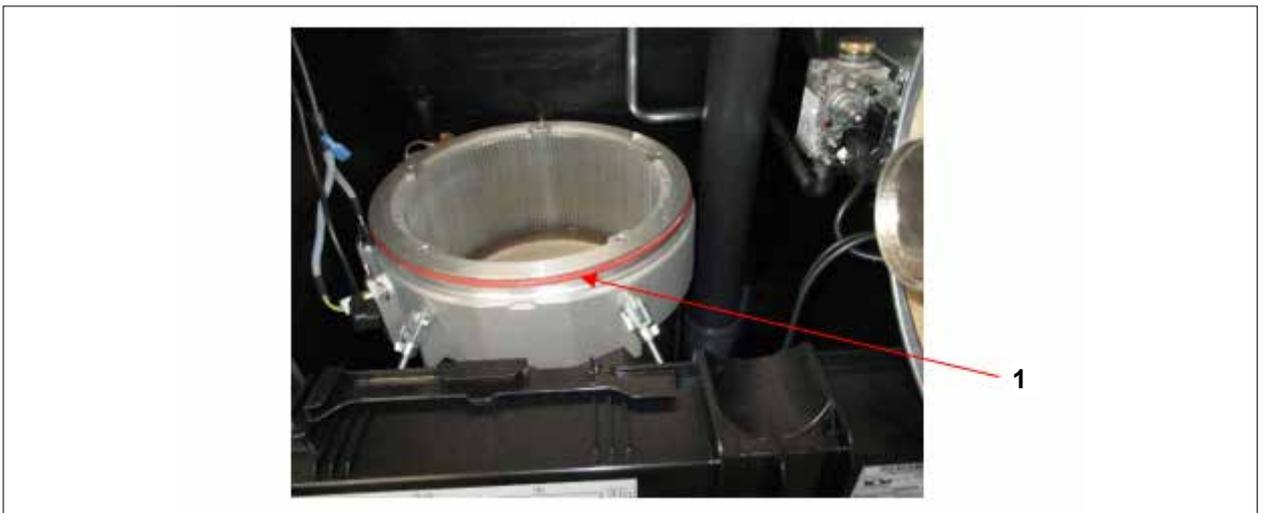
**Abb. 5.21 Dichtring Brennkammerdeckel**
