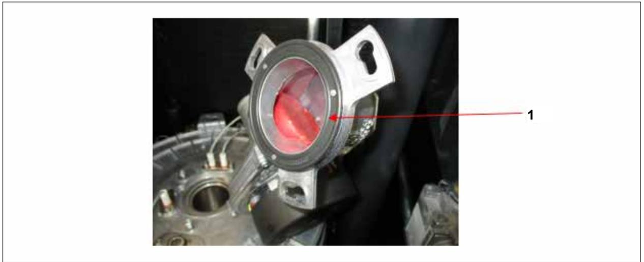
**Abb. 5.9 Brennerdichtung tauschen**
