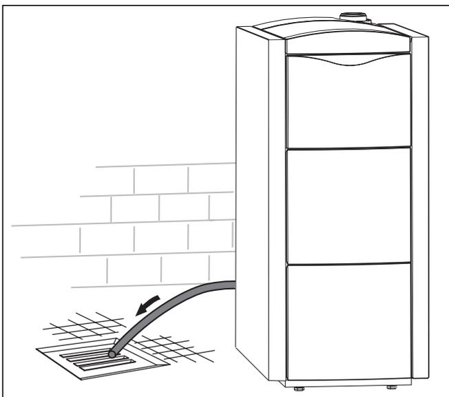
Fig. 5.8 Kondenswasserablauf montieren
