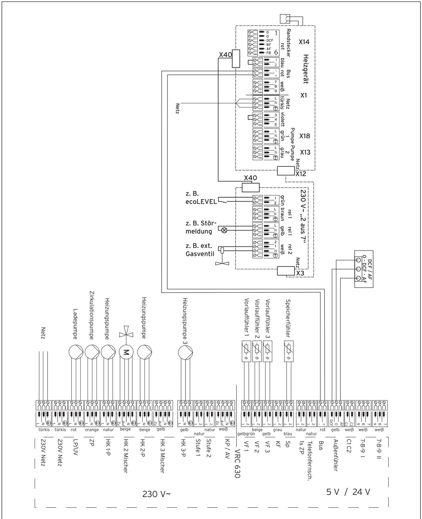
Abb. 5.15 Anschluss Regelgerät VRS 620 oder VRC 630
