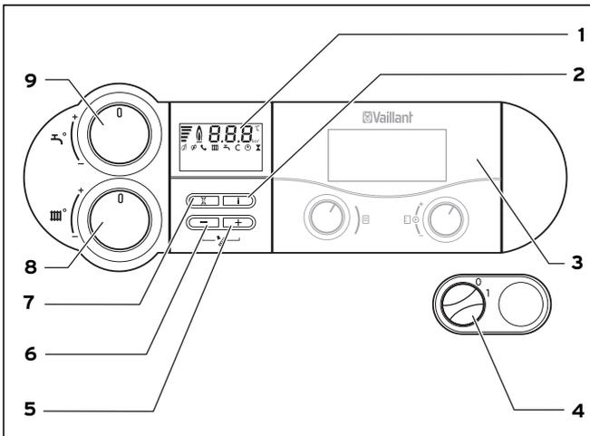
Abb. 3.1 Übersicht über die Bedienelemente
