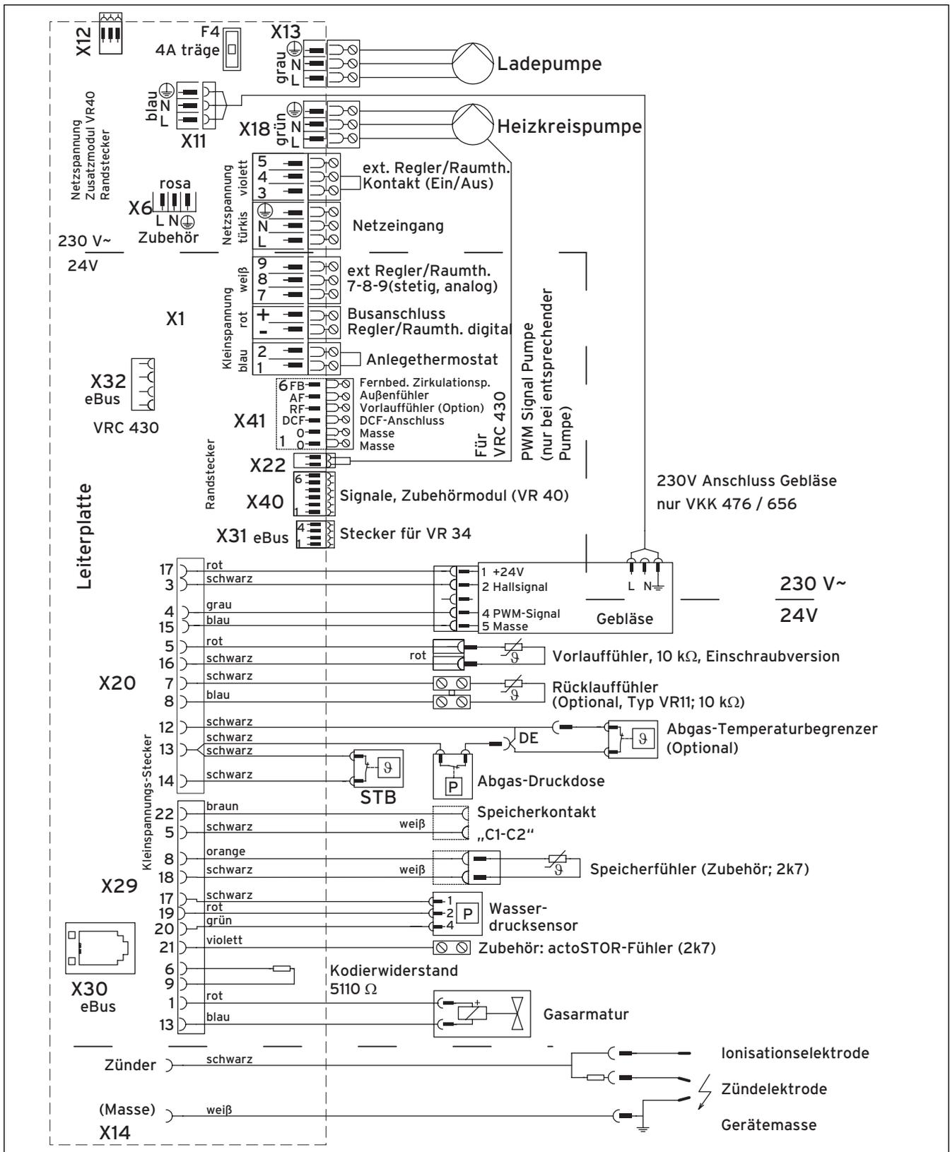
Abb. 5.13 Anschluss elektrischer Zubehöre und interne Verdrahtung
