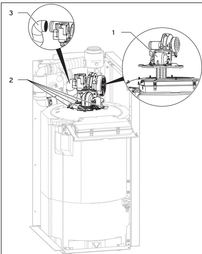
Abb. 8.1 Brenner demontieren
