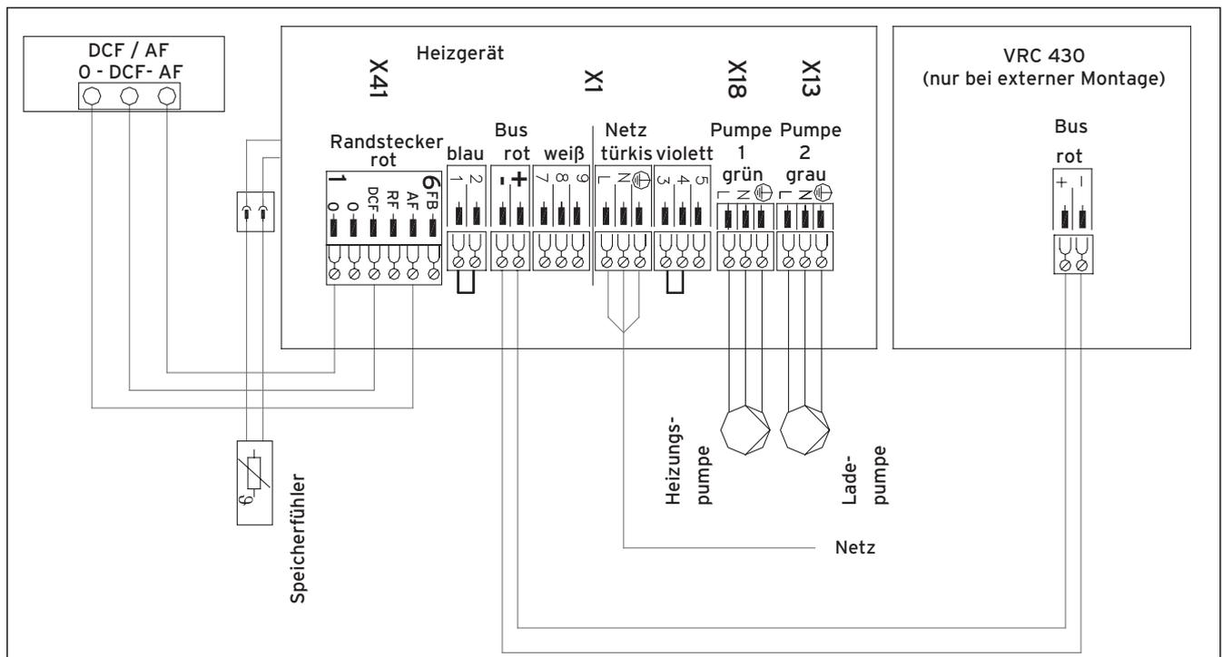
Abb. 5.14 Anschluss Regelgerät VRC 430
