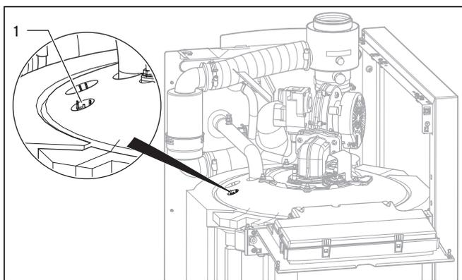
**Abb. 9.1** Sicherheitstemperaturbegrenzer entriegeln
