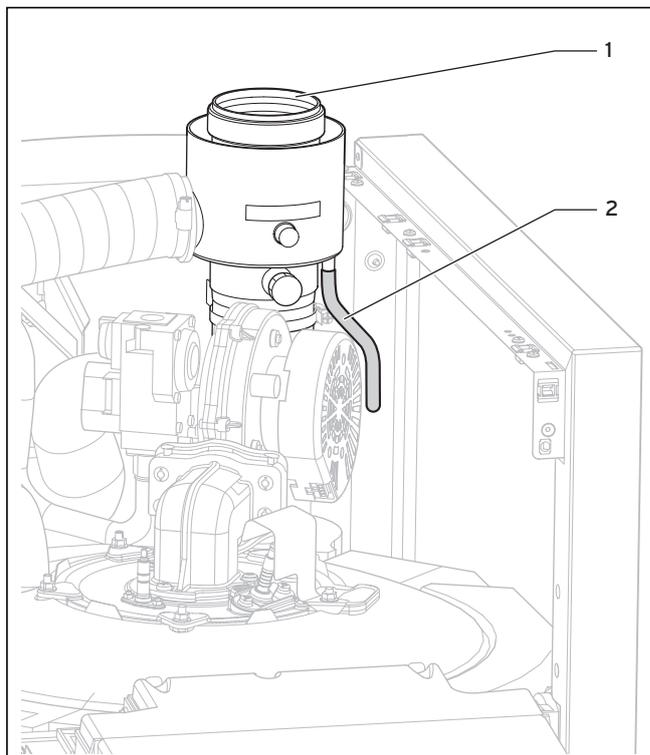
Abb. 5.9 Siphon befüllen
