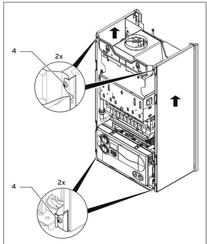
Abb. 4.8 Seitenverkleidung demontieren
