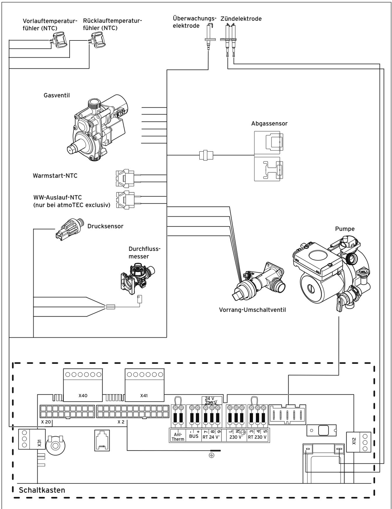
Abb. 5.12 Verdrahtungsplan atmoTEC exclusiv / atmoTEC plus
