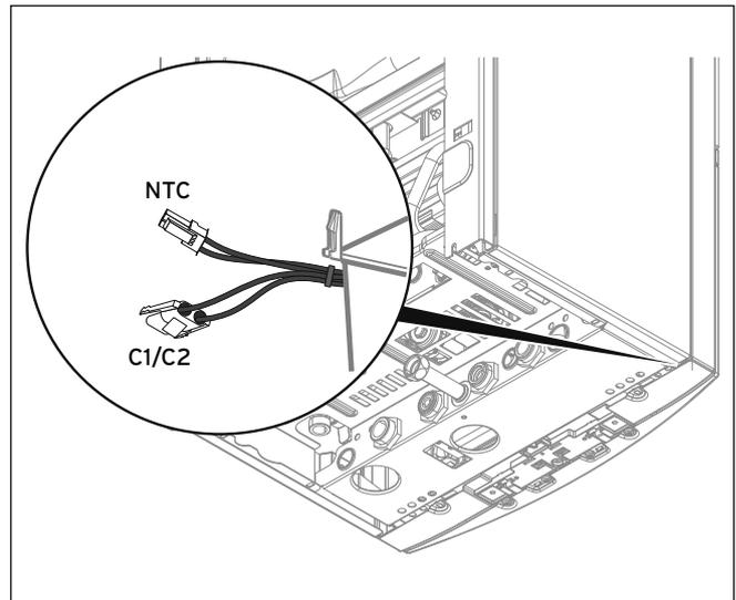
Abb. 5.10 Speicheranschluss (elektrisch)
