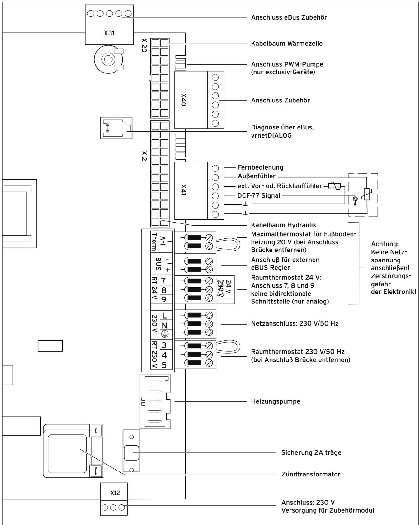
Abb. 5.11 Anschlussplan atmoTEC exclusiv / atmoTEC plus
