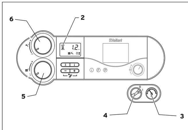
Abb. 6.3 Fülldruck der Heizungsanlage prüfen
