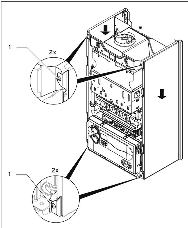
Abb. 4.9 Seitenverkleidung montieren
