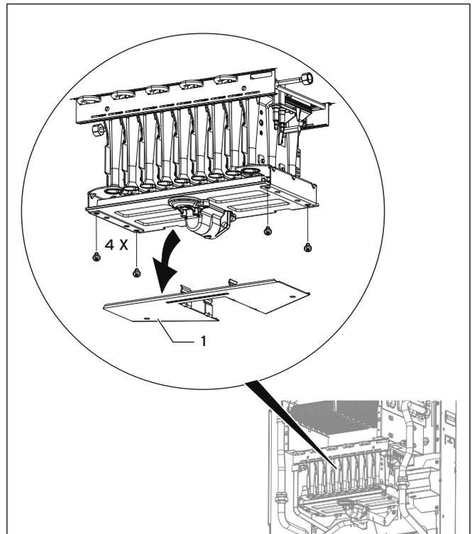
Abb. 7.7 Düsenplatte demontieren
