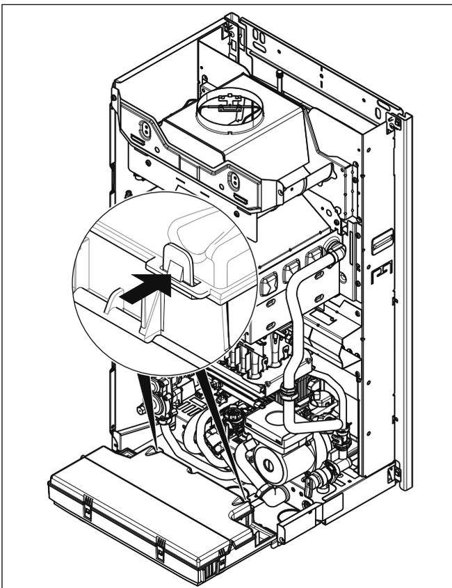
Abb. 5.7 Schaltkastenrückwand öffnen
