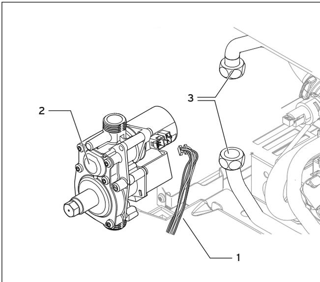
Abb. 7.9 Gasarmatur wechseln
