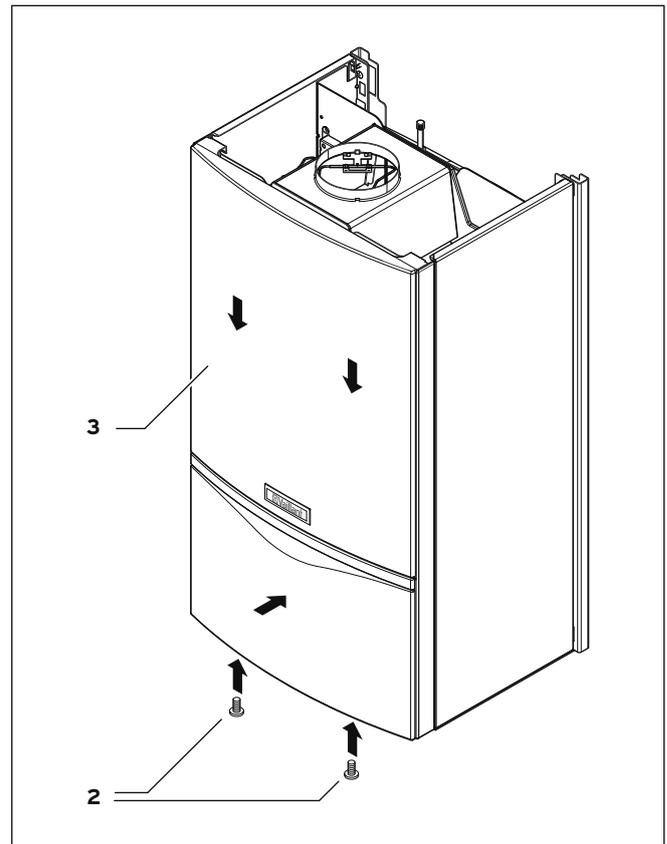
Abb. 4.10 Gerätefrontverkleidung montieren
