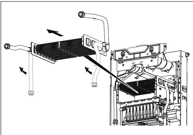
**Abb. 8.5 Primärwärmetauscher herausziehen**
