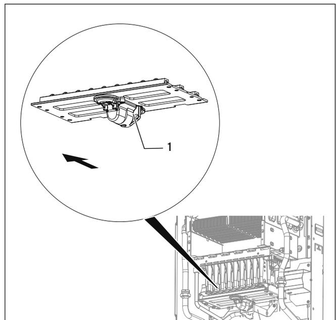
Abb. 7.8 Düsenplatte entfernen
