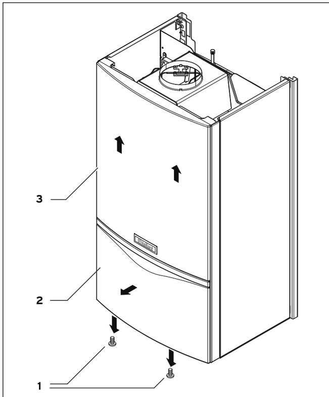
Abb. 4.7 Gerätefrontverkleidung demontieren
