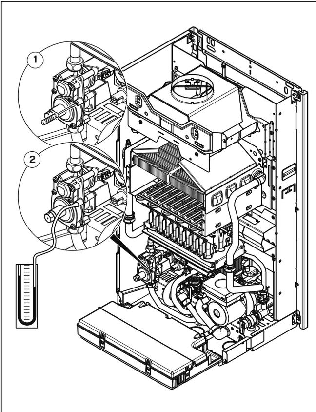
Abb. 6.4 Anschlussdruck prüfen
