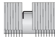
Bild 2: Abdeckung 90° drehen und herausnehmen
