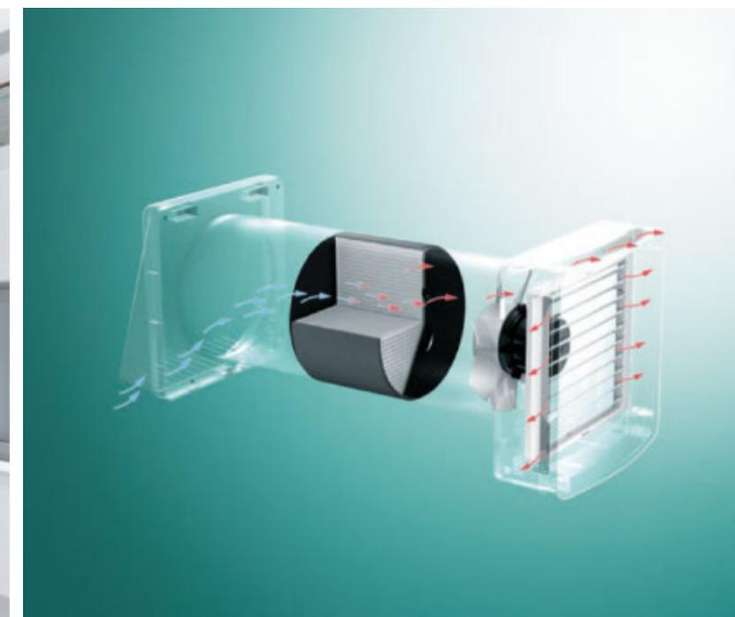
Wärmerückgewinnung über Keramikwärmespeicher bei dezentraler Lüftung
