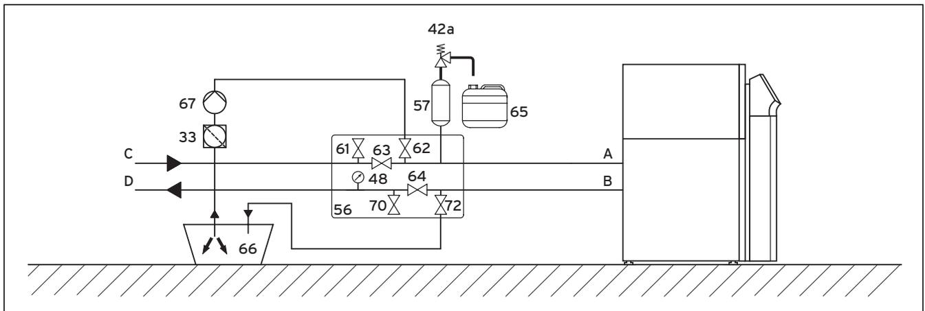
Abb. 6.5 Inneren Teil des Solekreises befüllen und entlüften
