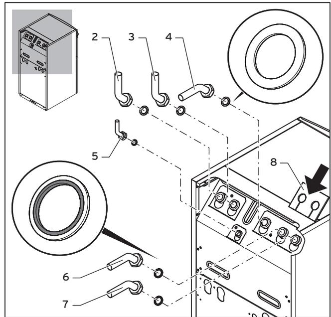
**Abb. 5.6 Anschlusswinkel montieren**
