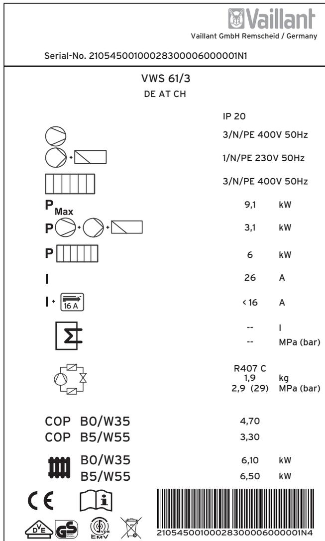
Abb. 3.1 Beispiel für ein Typenschild (VWS)
