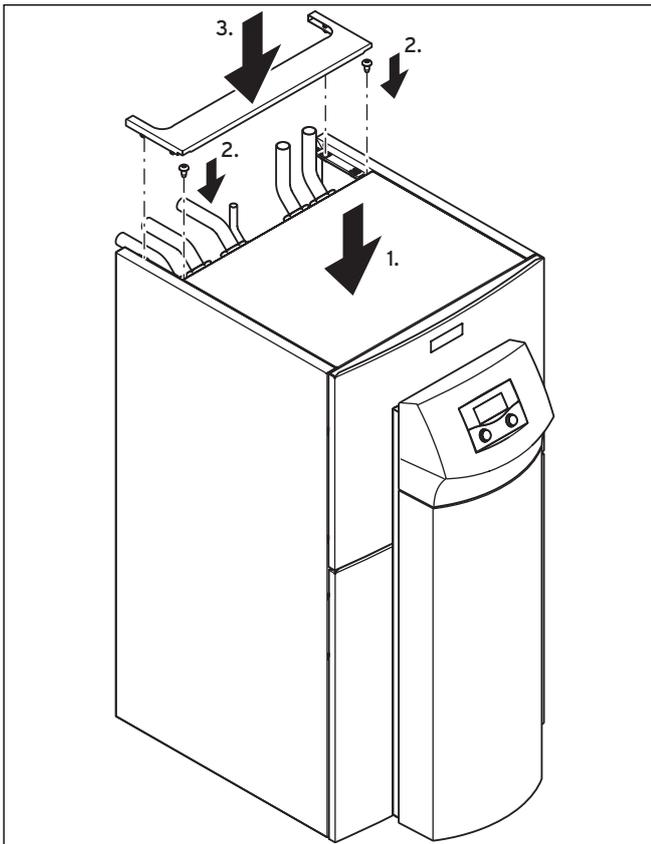
**Abb. 7.21 Obere Verkleidungsteile montieren**
