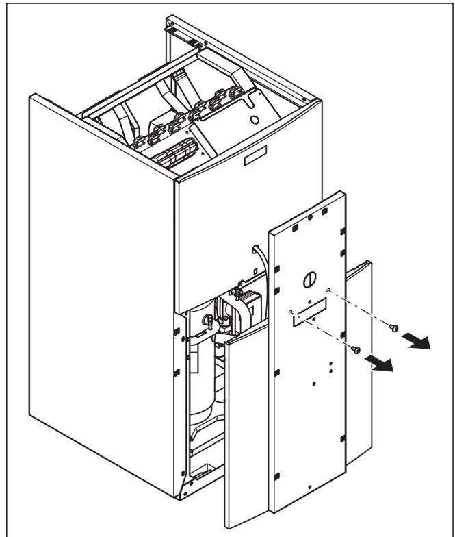
Abb. 4.8 Unterteil der Frontverkleidung abnehmen
