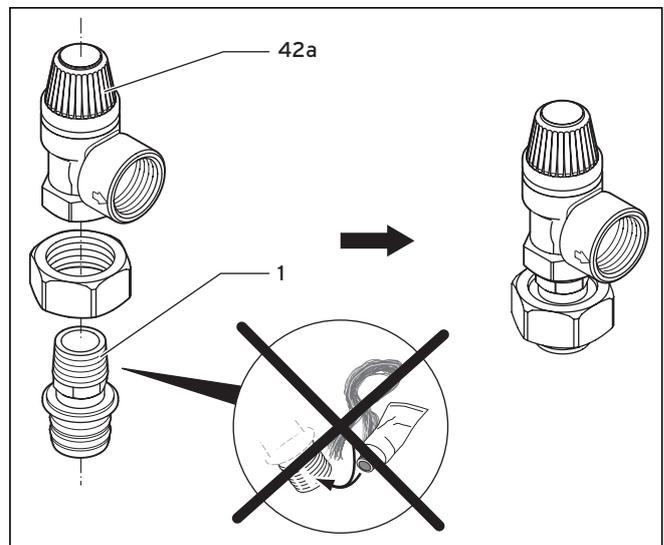
**Abb. 5.9 Sicherheitsventil montieren**
