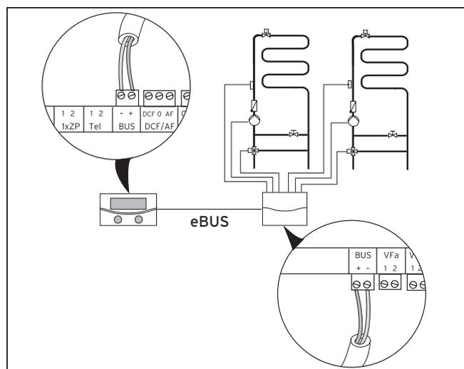
**Abb. 7.13 Weitere Mischerkreise mit VR 60 installieren**
