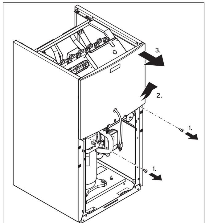
Abb. 4.9 Oberteil der Frontverkleidung abnehmen
