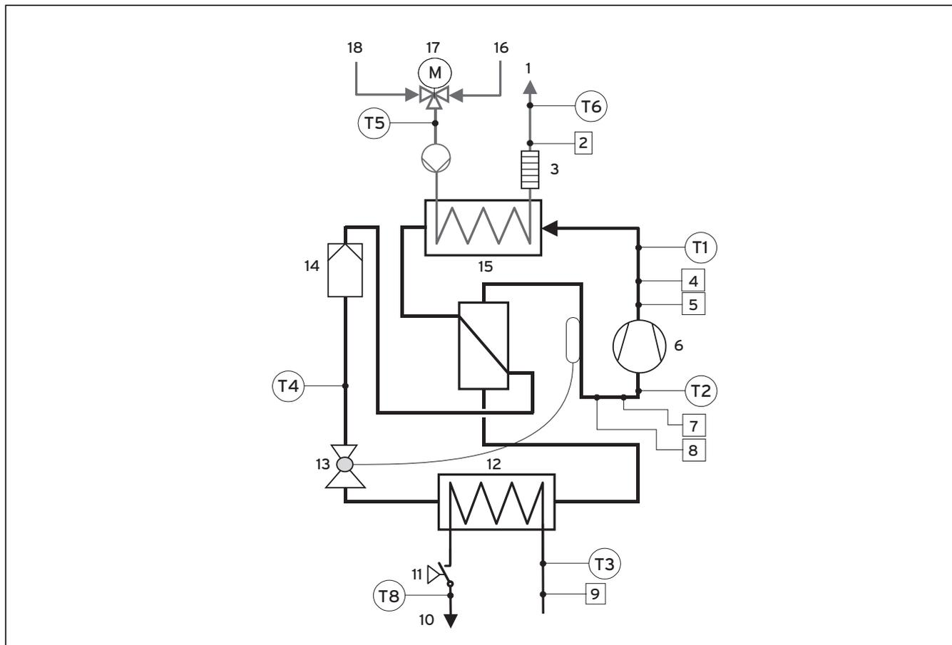
Abb. 2, Anhang, Wärmepumpenschema VWW ..1/3
