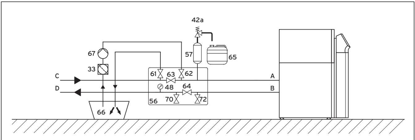
**Abb. 6.6 Gesamten Solekreis in einem Arbeitsgang befüllen und entlüften**
