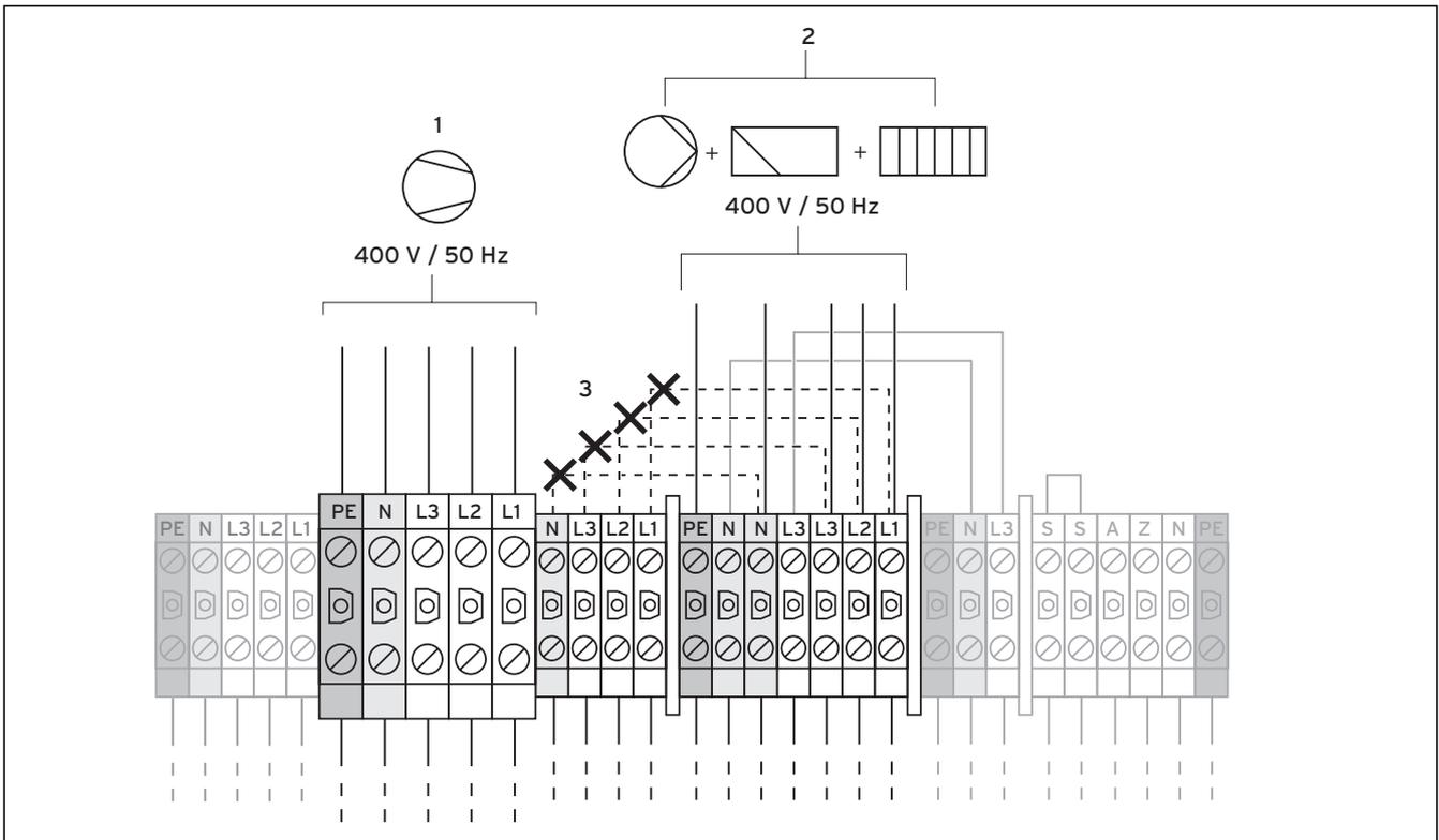
**Abb. 7.3 Zweikreis-Einspeisung Wärmepumpen-Tarif**
