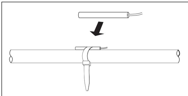
**Abb. 7.10 Standardfühler VR 10 als Anlegefühler installieren**
