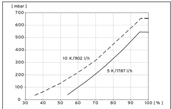
**Abb. 9.8 Diagramm Leistungsoptimierung Heizkreispumpe VWS 101/3**
