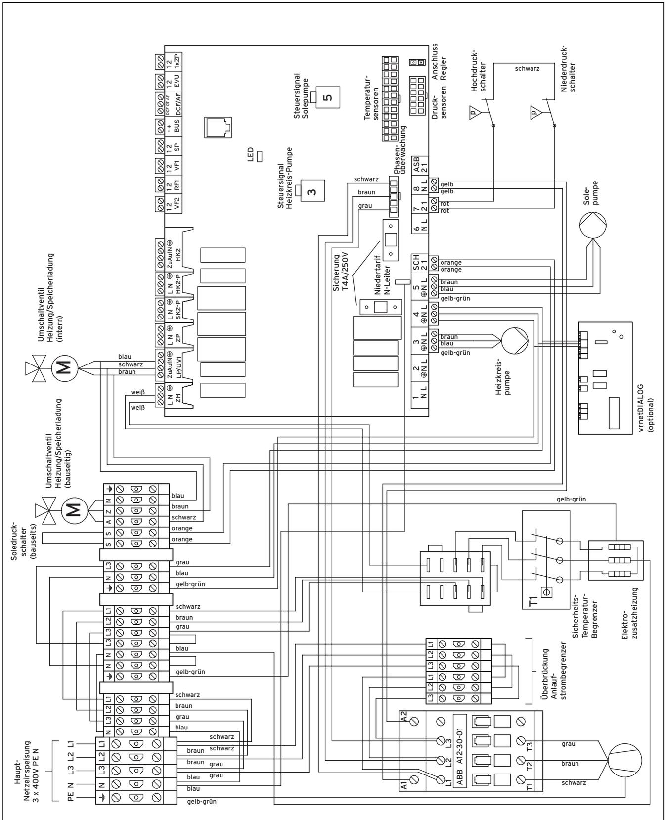
Abb. 3, Anhang, Stromlaufplan VWS 61/3 - VWS 141/3
