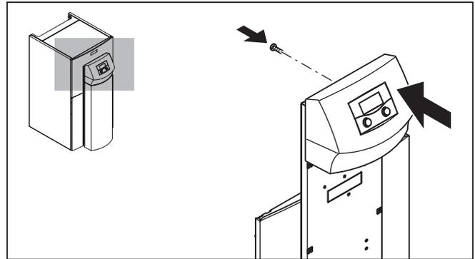
Abb. 7.17 Bedienkonsole montieren
