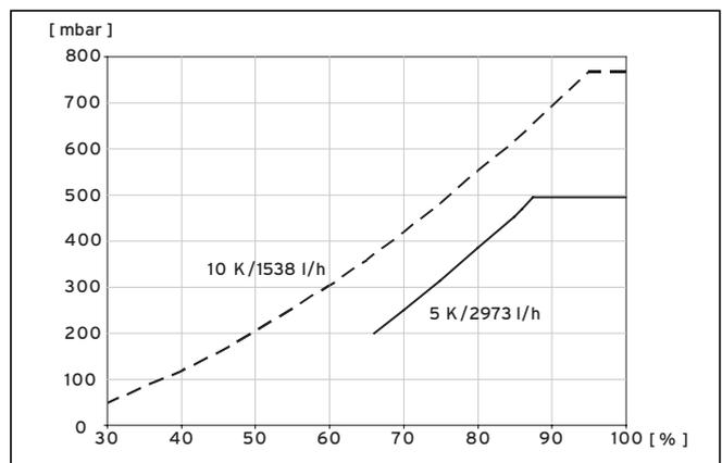
**Abb. 9.10 Diagramm Leistungsoptimierung Heizkreispumpe VWS 171/3**
