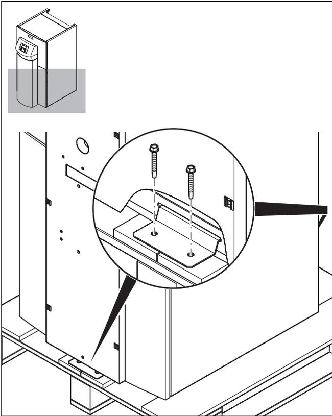
Abb. 4.4 Transportsicherungen entfernen
