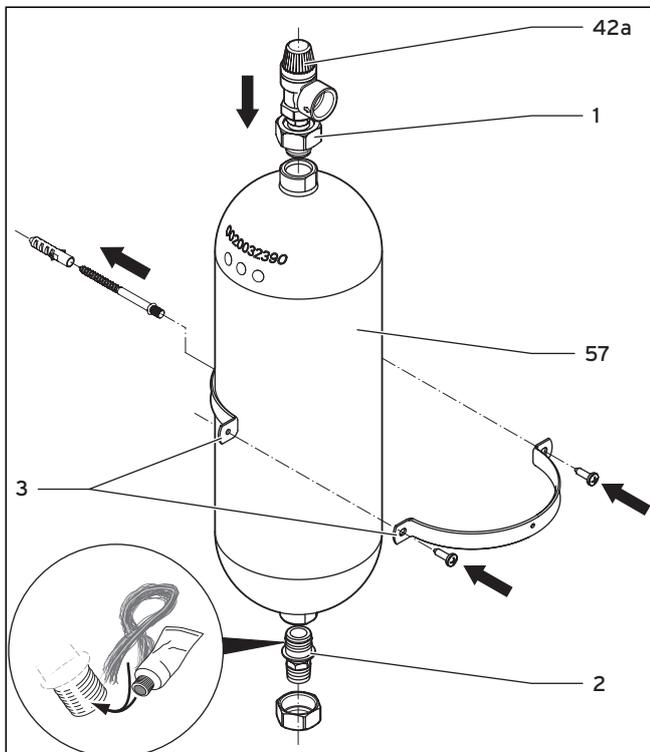
**Abb. 5.8 Sole-Ausgleichsbehälter montieren**
