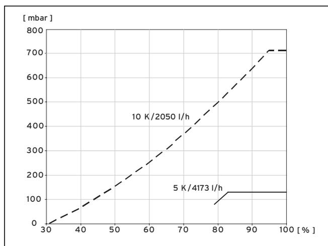
**Abb. 9.10 Diagramm Leistungsoptimierung Heizkreispumpe VWW 171/3**
