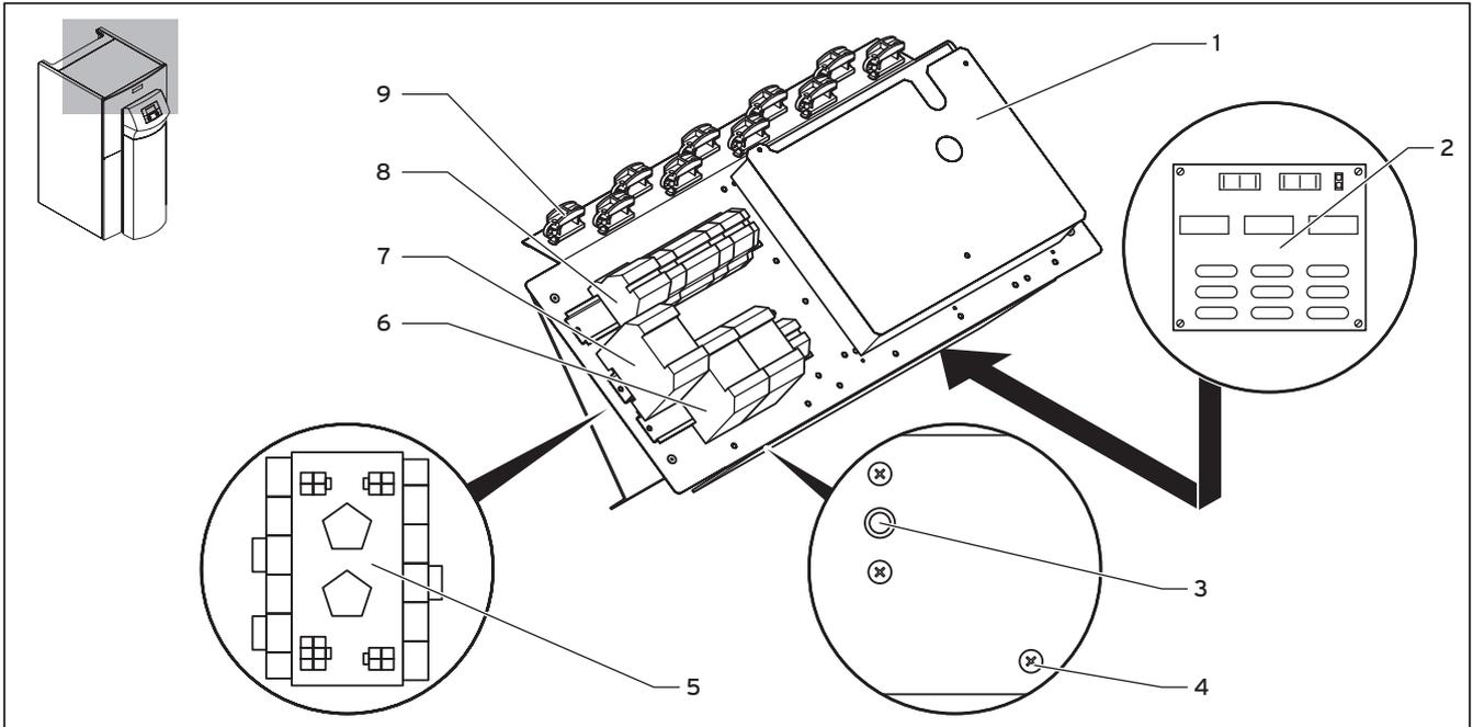
**Abb. 7.1 Elektro-Schaltkasten (VWW)**
