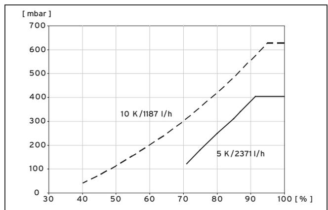
**Abb. 9.9 Diagramm Leistungsoptimierung Heizkreispumpe VWS 141/3**
