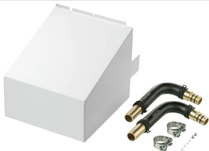
Das Anschlussset ist für die Verbindung von aus dem Erdreich kommende Versorgungsleitungen 32 x 2,9 geeignet. Im Lieferumfang befinden sich neben den Verbindungsstücken eine weiß lackierte Abdeckhaube zum Schutz vor Witterungseinflüssen.
