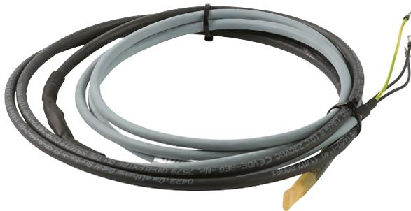
Selbstlimitierendes flexibles Heizband zur Frostfreihaltung des Kondensatanschlusses bei Luft | Wasser-Wärmepumpen. Beide Varianten haben ein Anschlusskabel von 2 m Länge. Beheizte Länge: HZB-1: 1 m, HZB-2: 2 m.
