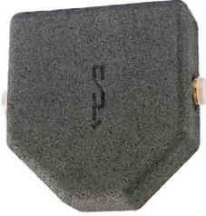
Multifunktions-Sole-Füllereinheit inklusive dampfdiffusionsdichter Isolierung zum Befüllen und Spülen des Solekreislaufs, zur einfachen und schnellen Installation auf der Wärmequellenseite. Einsetzbar für Sole | Wasser-Wärmepumpen mit einer Heizleistung bis zu 16 kW. Zur weiteren Ausstattung gehören ein Sole-Sicherheitsventil, Manometer, Filter, Schnelllüfter und Mikroblasenabscheider.
