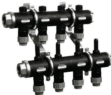
Vor- und Rücklaufverteiler aus Kunststoff für Solekreise. Jeder Solekreis absperrbar durch Kugelhähne mit Klemmfittings; Anschlüsse an Vor- und Rücklauf R 1 1/4, inkl. Wandhalterungen und Entlüfter pro Verteiler.
