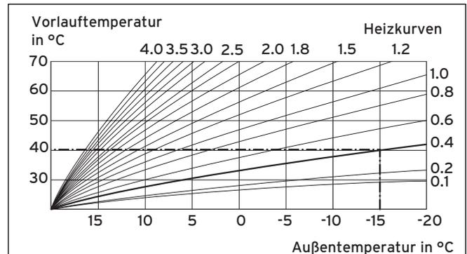
Abb. 1 Diagramm Heizkurven
