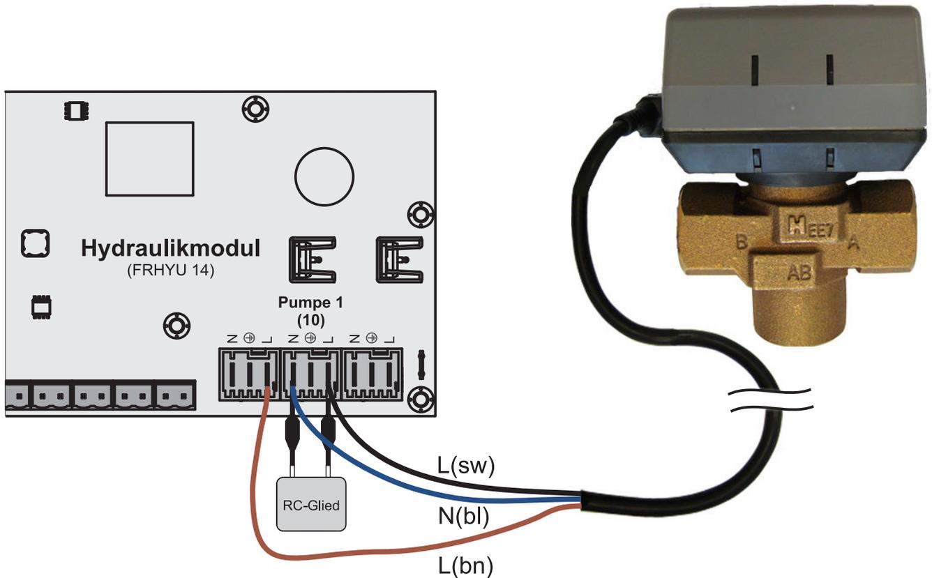
Der Außenleiter L(bn) ist am Außenleiter der jeweiligen Netzversorgung des Moduls oder am Kernmodul, Ausgang HKP0/Brennerrelais am Pin „LV“ anzuschließen.
