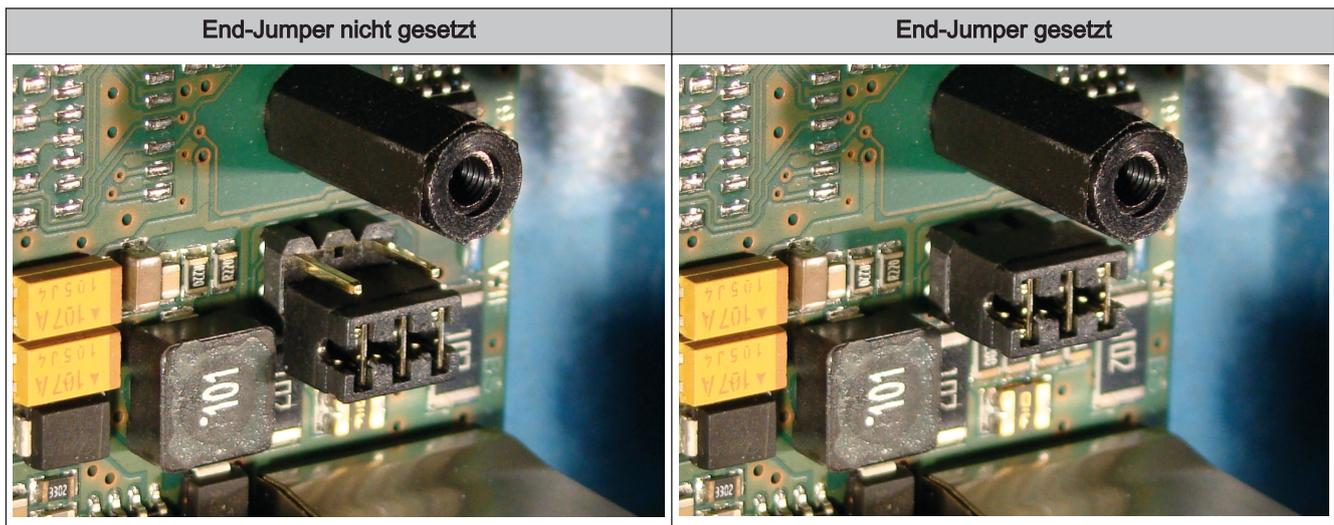
Sind die Kontakte am Sockel des End-Jumpers nicht gebrückt (Bild links), spricht man von "nicht gesetzt". In diesem Fall ist der Bus-Abschluss nicht hergestellt. Sind die Kontakte geschlossen (Bild rechts), ist der End-Jumper gesetzt und der Abschluss der Bus-Verbindung hergestellt.
